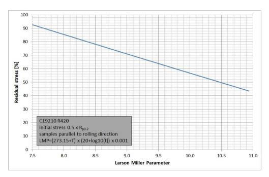
Die Relaxationsdaten werden als Restspannung über den Larson Miller Parameter aufgetragen. Der Larson Miller Parameter repräsentiert die Vergleichstemperatur und Testdauer. Test Methode: Mandrel Test entsprechend ASTM E328.
